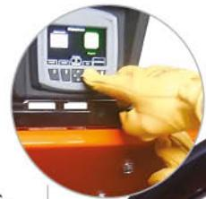
**Tablero digital** que permite controlar todos los parámetros de la máquina, detener y activar la alimentación, y acceder a la información de mantenimiento.
