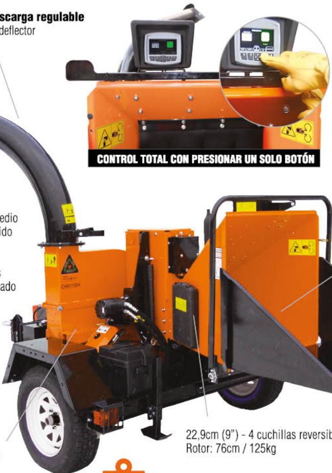
**Tablero digital** que permite controlar todos los parámetros de la máquina, detener y activar la alimentación, y acceder a la información de mantenimiento.
