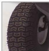
Cubiertas con dibujo Turf Saver que reduce las huellas sobre el césped.
